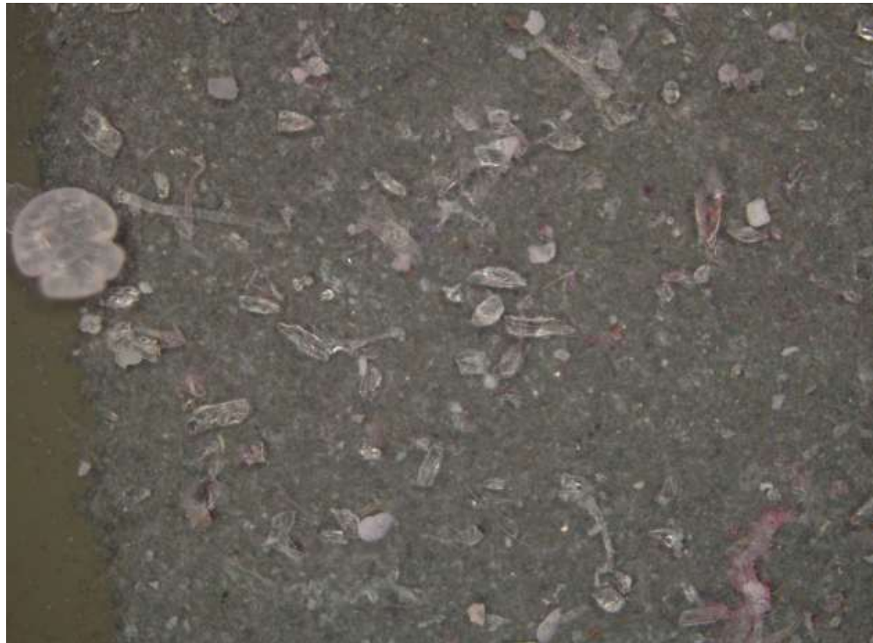
Slika 9. Uvećanje 200x, nasumično odabrana pozicija na filteru, snimljeno pomoću ekscitacionog filtera 510-550 nm.
