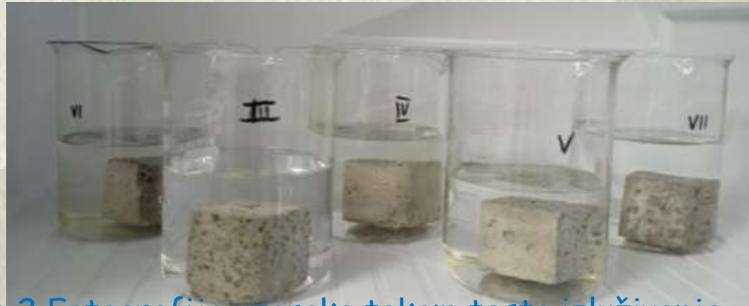
Slika 2 Fotografija uzoraka tokom testa izluživanja
