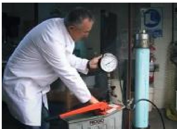
Slika 7. Testiranje PVC-O cevi na mehanička oštećenja
