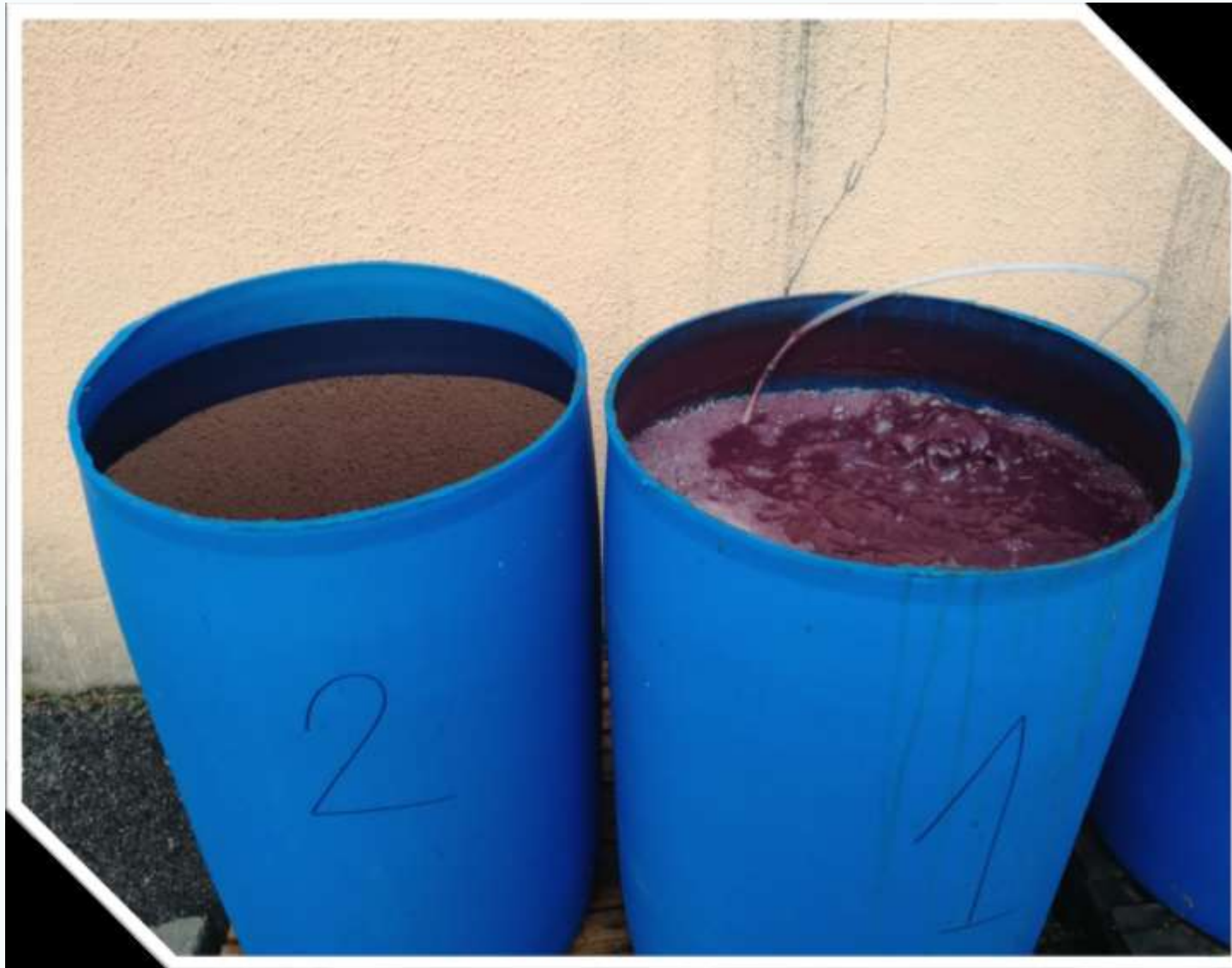
Slika 1. Bačva 1, u kojoj je uključen sistem za uduvavanje vazduha, i bačva 2
